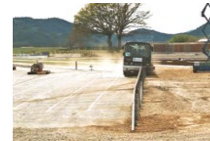
Prova dimostrativa del corretto comportamento di una barriera su un terreno piano e ben compattato
