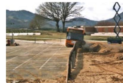
Prova dimostrativa del comportamento di una barriera installata su arginello con il sistema S.C.Re.W.S.
