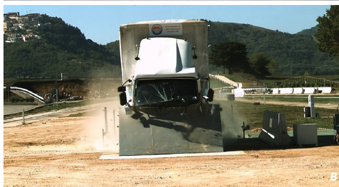
4A e 4B. Esecuzione di crash test al vero presso il centro Aisico 4A and 4B. Real crash tests performed at the Aisico center
